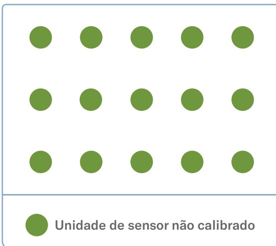
Figura 6: Exemplo de colocação de sensor para teste de comparabilidade
